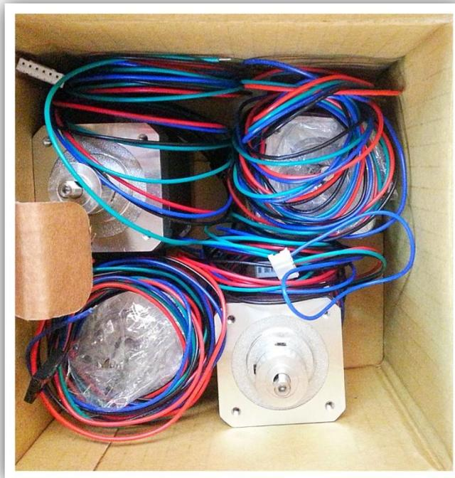
Dos de los motores son de alto Torque, y estos poseen una polea que deberá ser ajustada y dos de bajo torque más pequeños.
